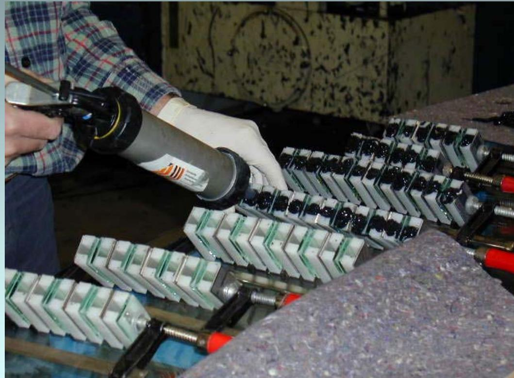
Herstellung von H-Prüfkörpern zur
